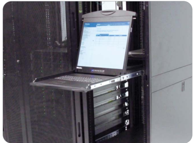
T1900 KVM-Konsole von Raritan, am Dominion KX II angeschlossen
